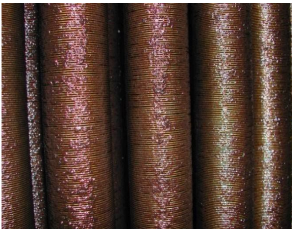
Jamoksiderande bakteriar i råvatnet som førte til avleiringar på trykksilar og i reintvassbasseng i Gamleidet VB1
